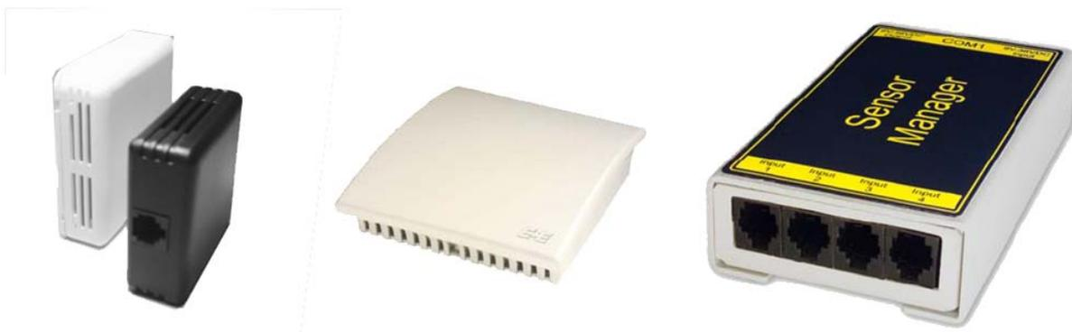
SENSOR MANAGER – die Erweiterung des CS121 Webadapters zum Gebäudemanagement Gerät : Mess- und Schaltmodul für 8 analoge Eingänge (für Temperatur, Feuchtigkeit, Druck usw. -alle Sensoren zwischen 0-10Volt), zusätzlich 4 digitale Eingänge und 4 digitale Ausgänge für z.b. Alarmkontakte wie Rauch, Feuer, Wasser, Einbruch, Schaltrelais usw.
